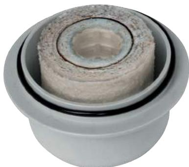
Condizione tipica del filtro dopo l'erogazione di 30.000 litri. Si consiglia la sostituzione della cartuccia del filtro una volta all'anno.
