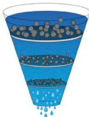
Filtrazione meccanica ad alta efficienza ( $\beta$  200) del particolato tramite un filtro incrementale sviluppato espressamente per l'AdBlue®.
